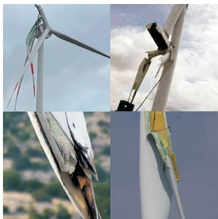
图 1 风力机叶片损伤
